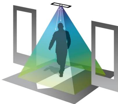
Der Erfassungsbereich wird von den Öffnungswinkeln des Time-of-Flight-Sensors bestimmt.
