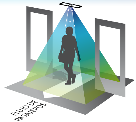
Versión Flush mount sCON-S: 58 × 43 × 188 mm
