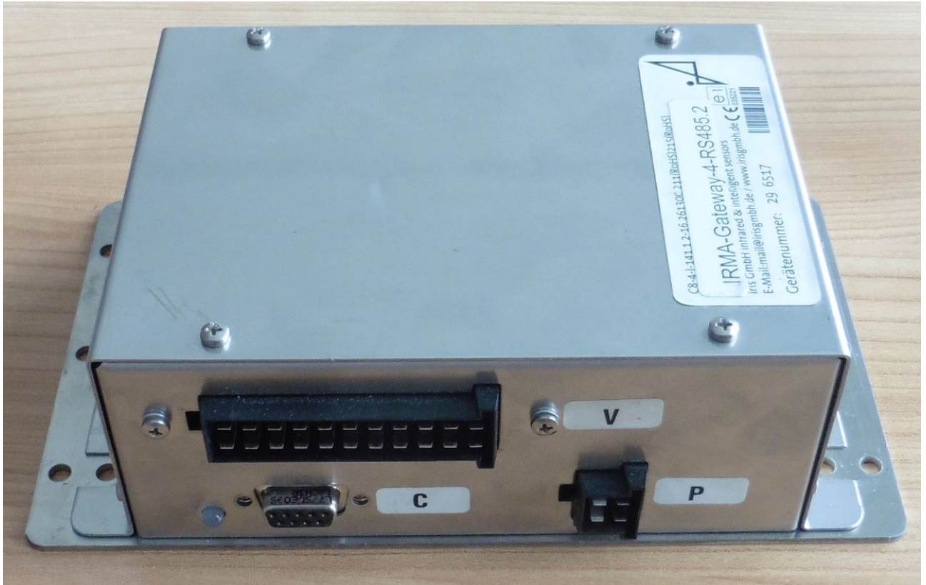
Abbildung 2: Ansicht IRMA-Gateway-4-RS485.2 auf Betriebsschnittstellen und Typetikett
