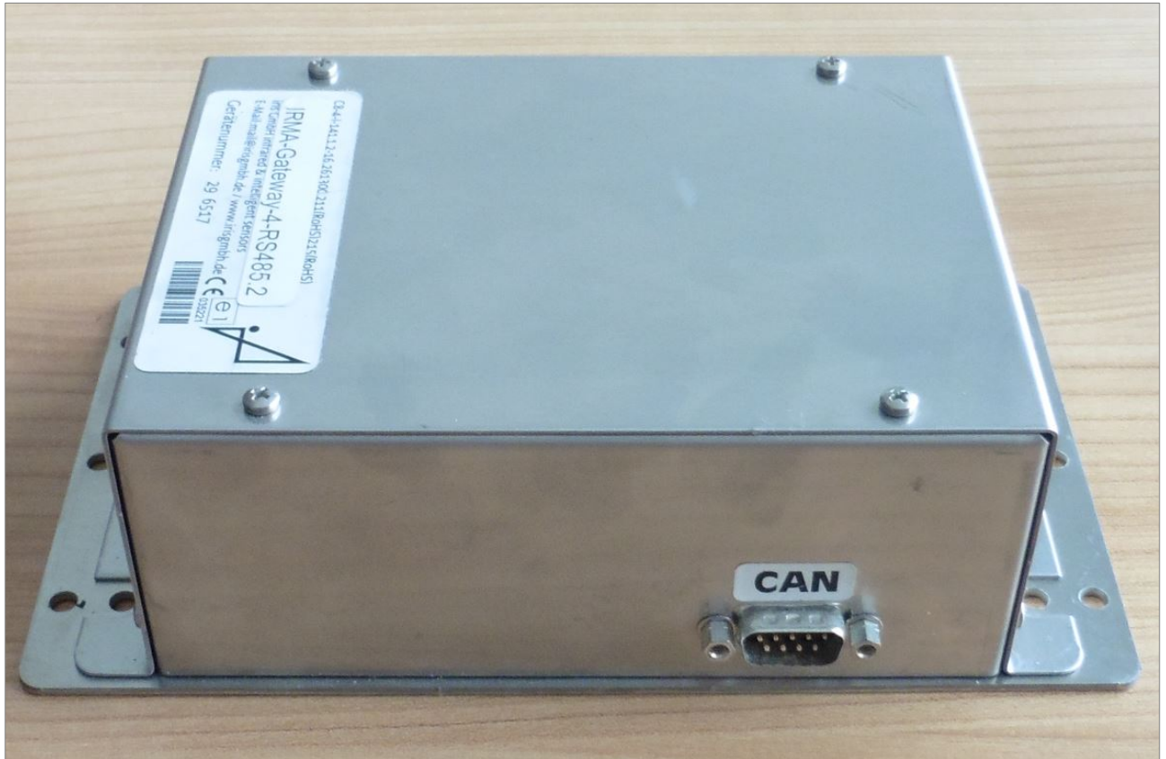
Abbildung 3: Ansicht IRMA-Gateway-4-RS485.2 auf CAN-Sensorsteckverbinder
