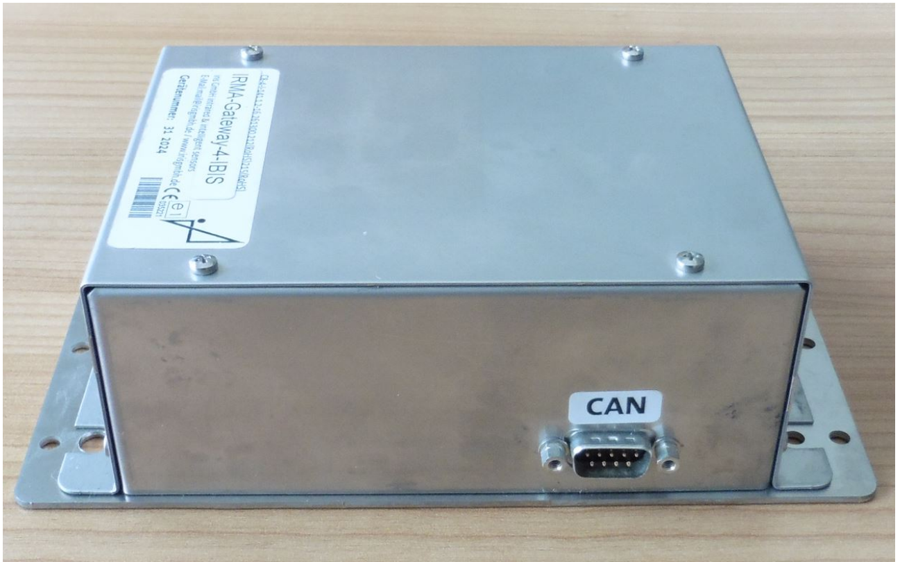
Abbildung 3: Ansicht IRMA-Gateway-4-IBIS auf CAN-Sensorsteckverbinder
