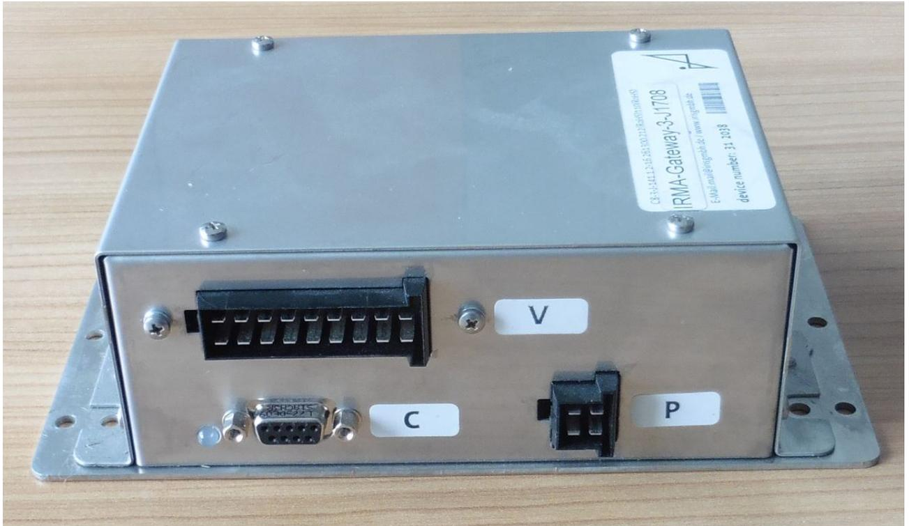
**Abbildung 2:** Ansicht IRMA-Gateway-3-J1708 auf Betriebsschnittstellen und Typetikett
