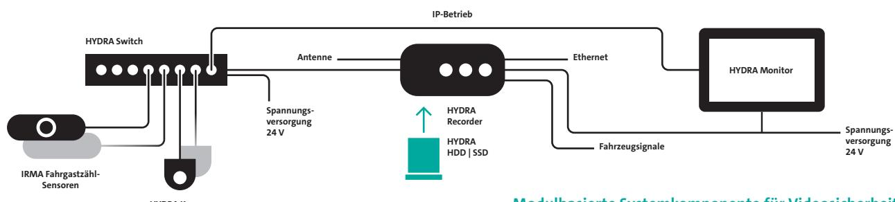
Modulbasierte Systemkomponente für Videosicherheit
